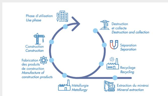
Les déchets métalliques sont recyclés en quasi-totalité et réintroduits dans le processus de production. Dans le cas de l'acier et de l'aluminium, leurs propriétés mécaniques facilitent grandement les opérations de tri qui peuvent s'opérer dans des centres de traitement hors site. Ainsi, en 2008, le gisement de métaux ferreux en fin de vie s'élevait à environ 12 millions de tonnes dont 7,1 millions de tonnes d'acier en provenance de la récupération (source ADEME) : l'ensemble a été recyclé !
